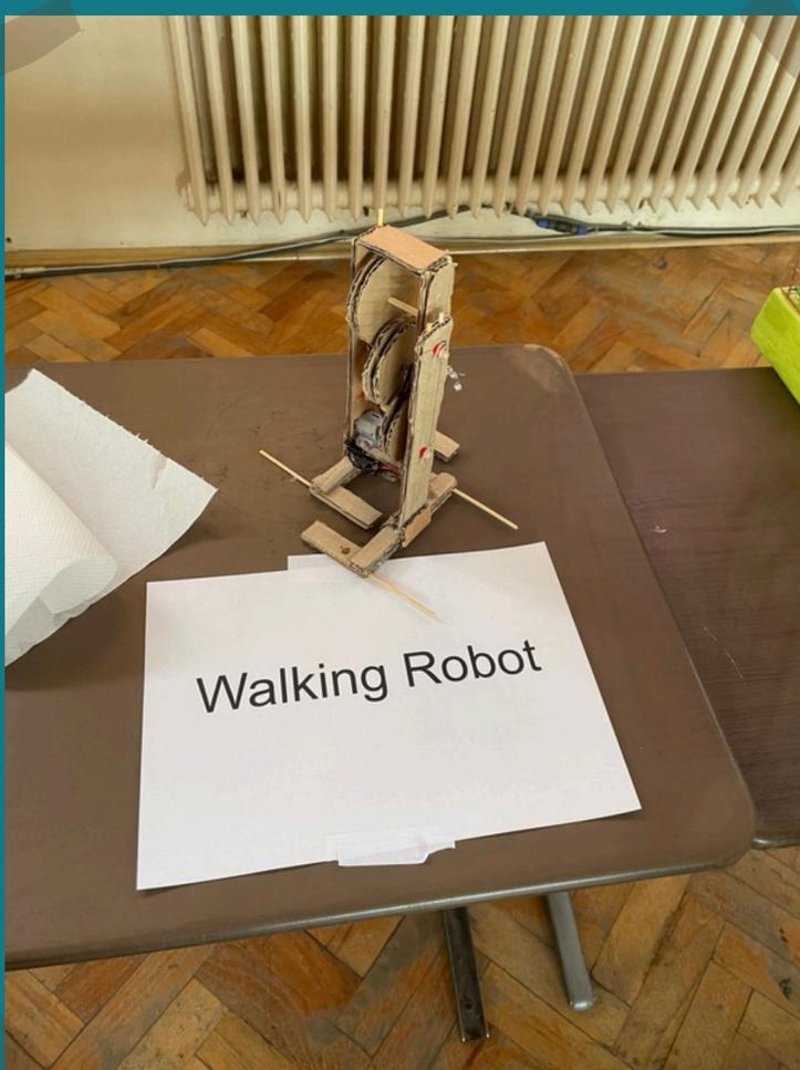
**Beschreibung:** das Projekt ist ein Laufroboter aus Karton, der nach dem Zusammengesetztenrollenprinzip arbeitet. Der Zweck des Roboters ist Transport von kleinen Objekten im Haushalt. Eine weitere Anwendung wäre, für die behinderte Menschen Essen oder andere Sachen zu bringen. Das Projekt ist aus wiederverwerteten Materialien gebaut.
